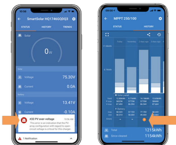
VictronConnect: captură de ecran pentru eroarea 33 și captură de ecran a istoricului care indică o eroare
